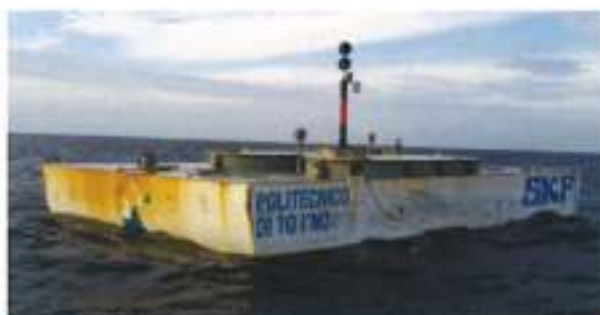
SLIKA 2. ISWEC inercijalni pretvarač energije morskog vala u radu (Izvor: Wave for Energy s.r.l.)
