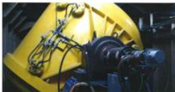
Slika 2. Žiroskop koji se nalazi u trupu jednog od prototipova ISWEC-a (Izvor: waveforenergy.com)
